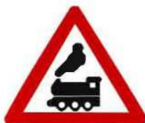
Железнодорожный переезд без шлагбаума
